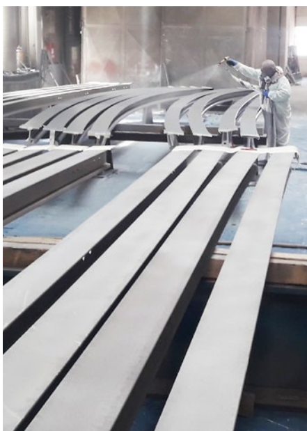
Abb. 8a und 8b: Werksbeschichtung und Baustellenanlieferung.
