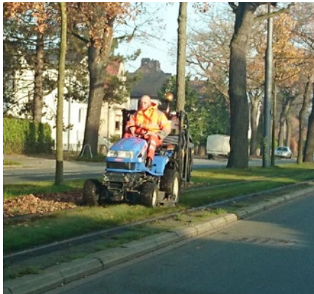
Abb. 2: Laubentfernung und Mahd per Aufsitzmäher auf hochliegend eingedecktem Gleis. Foto: C. Schade
